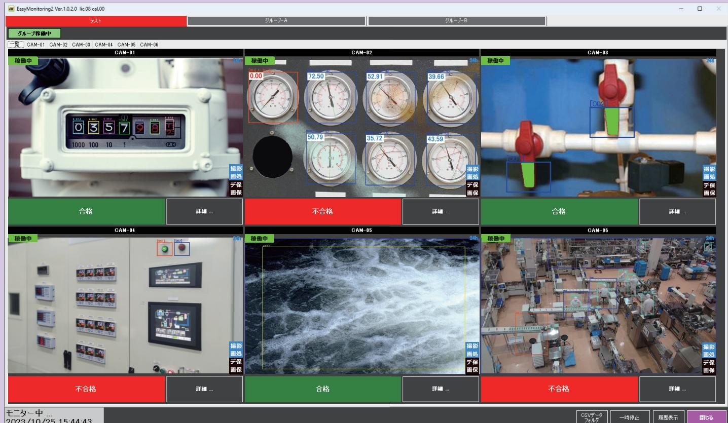
画像を読み込み、画像処理ソフトで読み取りや物体検知をして合否判定を行い、これまで人が行っていた確認作業を自動化します。
